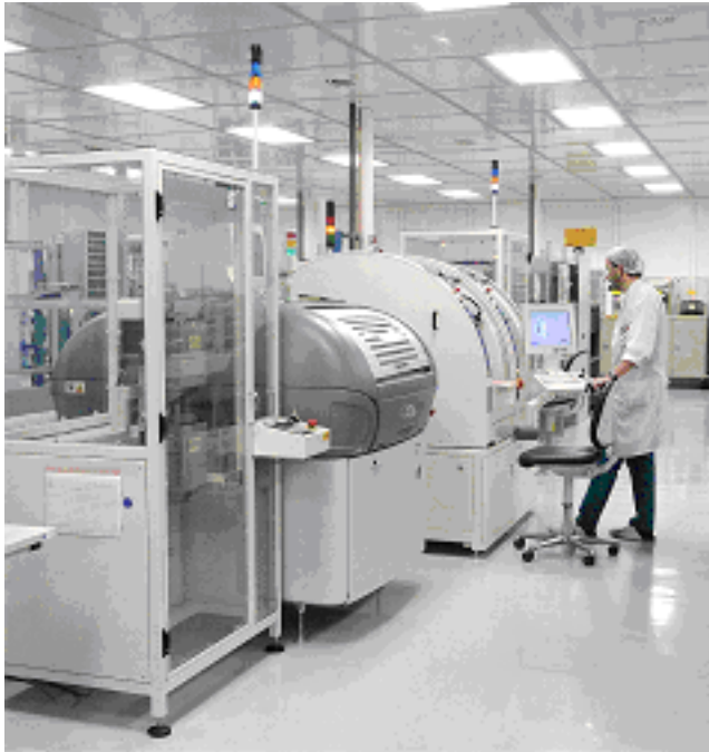
Bild 4-2: Halbleiterbestückungslinie im Reinraumbereich der Fertigung
