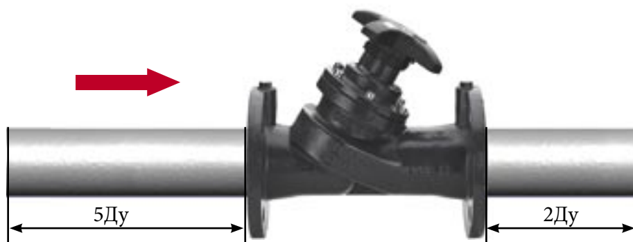
Рис.2. Монтаж клапана MSV-F2 на трубе
