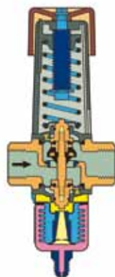
WVFX keresztmetszet (nyomásszabályozott)
