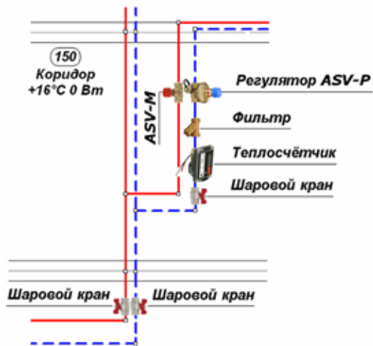
Узел присоединения квартирной приборной ветки с ASV-P
