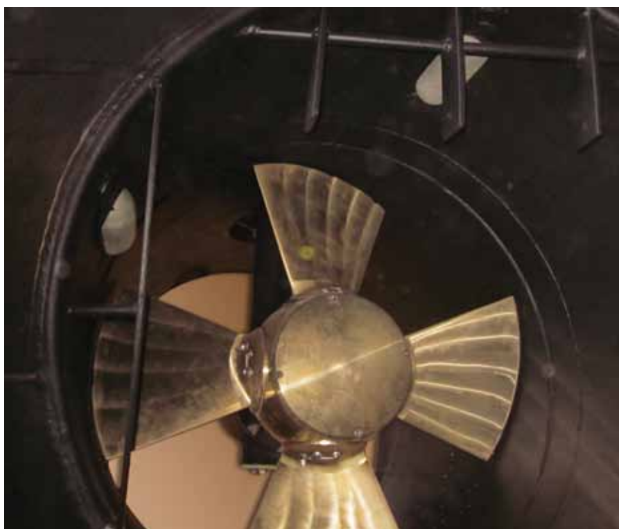
Tunnel thruster aboard the MV Fugløyhav
