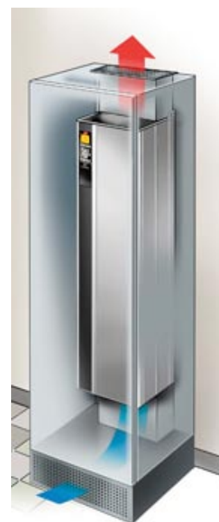
Refroidissement par l'arrière, sans passer dans l'armoire.
