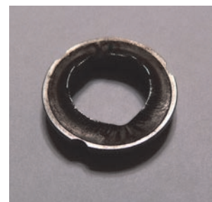
Рис. 4 Седло клапана NRVA.
