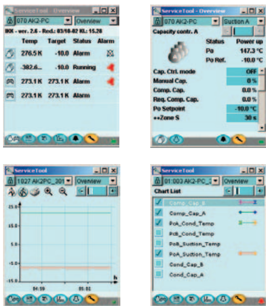
Рис. 7. Примеры показаний программатора АК2
