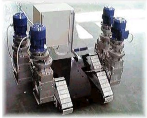
Rys. 2. Model 1:30 napędu gąsienic w koparce SRs 1200 z silnikami AC zasilanymi z 4 przetwornic częstotliwości
