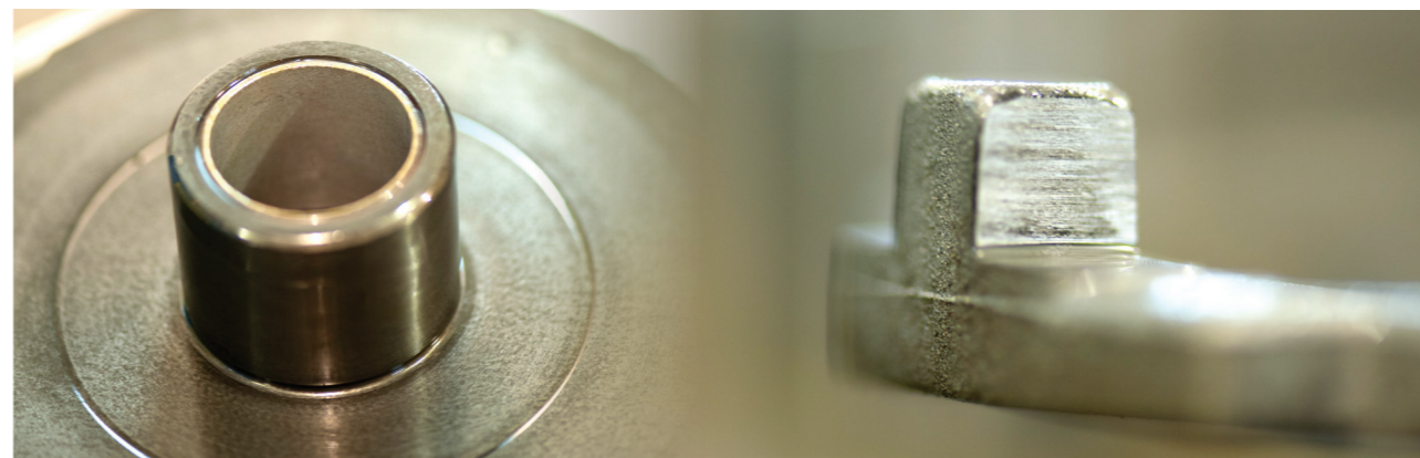
Подшипник подвижной спирали — следов износа нет.
