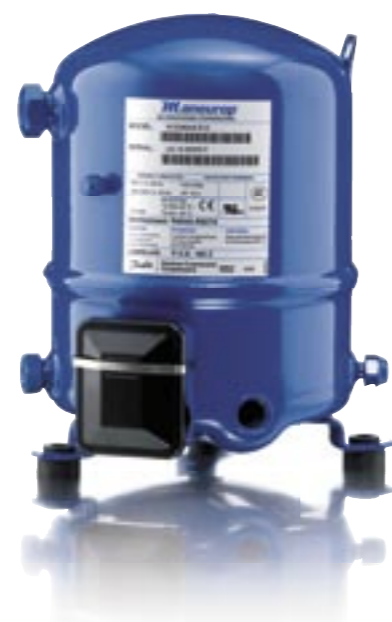
NTZ: dedicati alla refrigerazione e stoccaggio alle basse temperature (T evap. da -10°C a -45°C).
