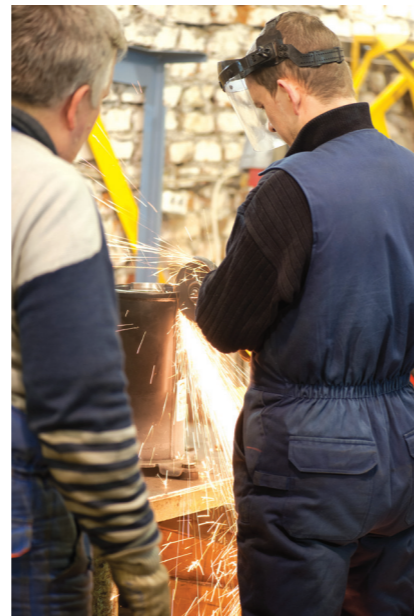
Процесс резки компрессора.
