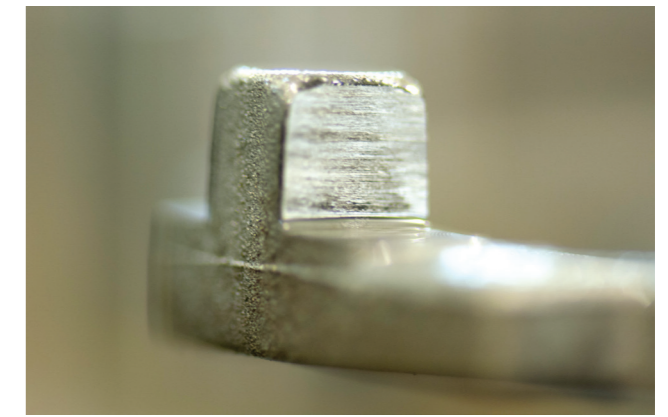
Муфта «Олдхэма» - небольшие потертости, которые являются следами нормальной работы.
