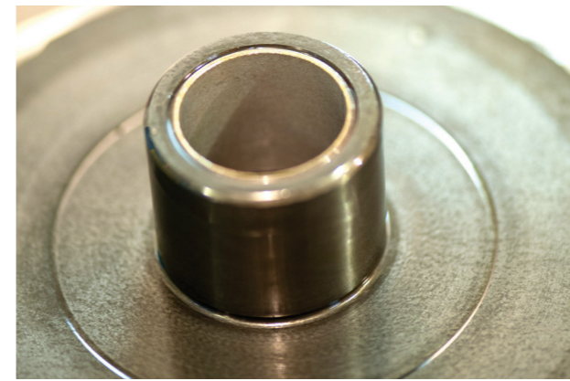
Подшипник подвижной спирали — следов износа нет.
